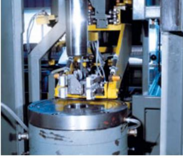
Şekillendirilmek üzere kalıba yönlendirilen kütük malzeme ve soğuk dövme ile şekillendirilmiş ürünler
