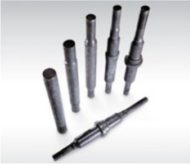
Şekillendirilmek üzere kalıba yönlendirilen kütük malzeme ve soğuk dövme ile şekillendirilmiş ürünler
