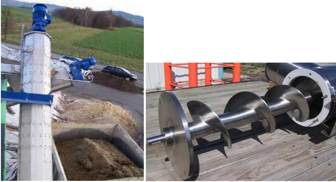
Şekil 22 Çürütücüye Besleme Stoku Yerleştirmek için Yıkama Mili, Besleme Pistonları ve Besleme Konveyörleri Sistemi
