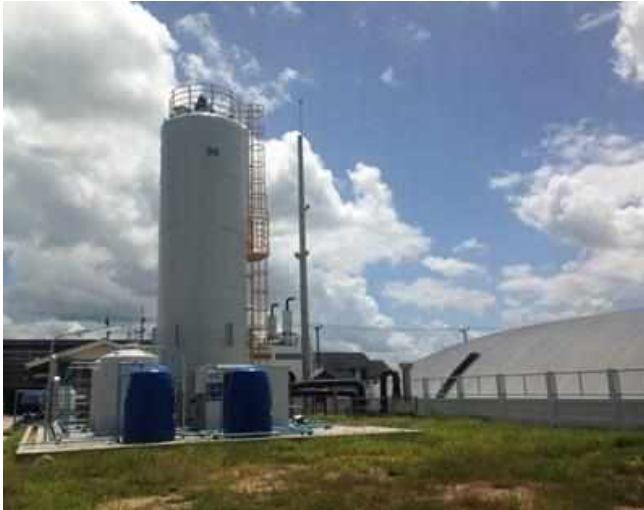
Şekil 32 Hidrojen sülfürün uzaklaştırılması için reaktör tankı
