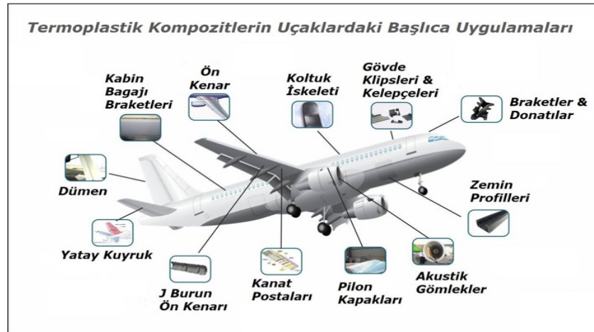
Şekil 8. Havacılık Sektöründe Termoplastik Kompozit Parça Örnekleri
