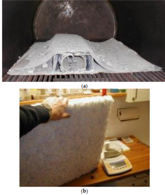
Şekil 15: Piroliz İşleminde Sonra Rüzgâr Kanadı (a) ve Ortaya Çıkan Elyaf Malzemesi (b)
