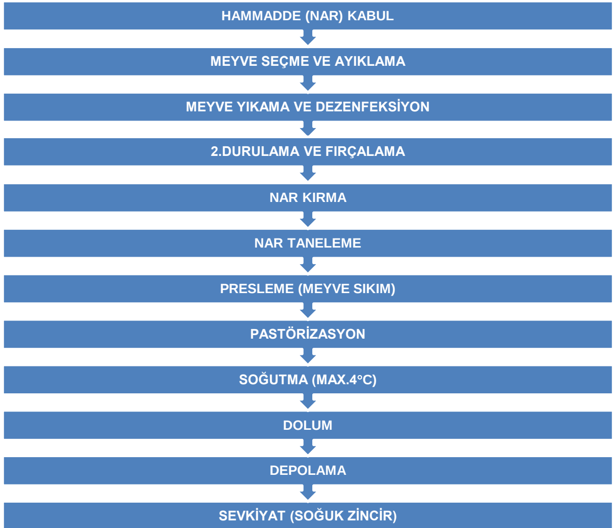
Şekil 5. NFC Nar Suyu İmalatı Akım Şeması
