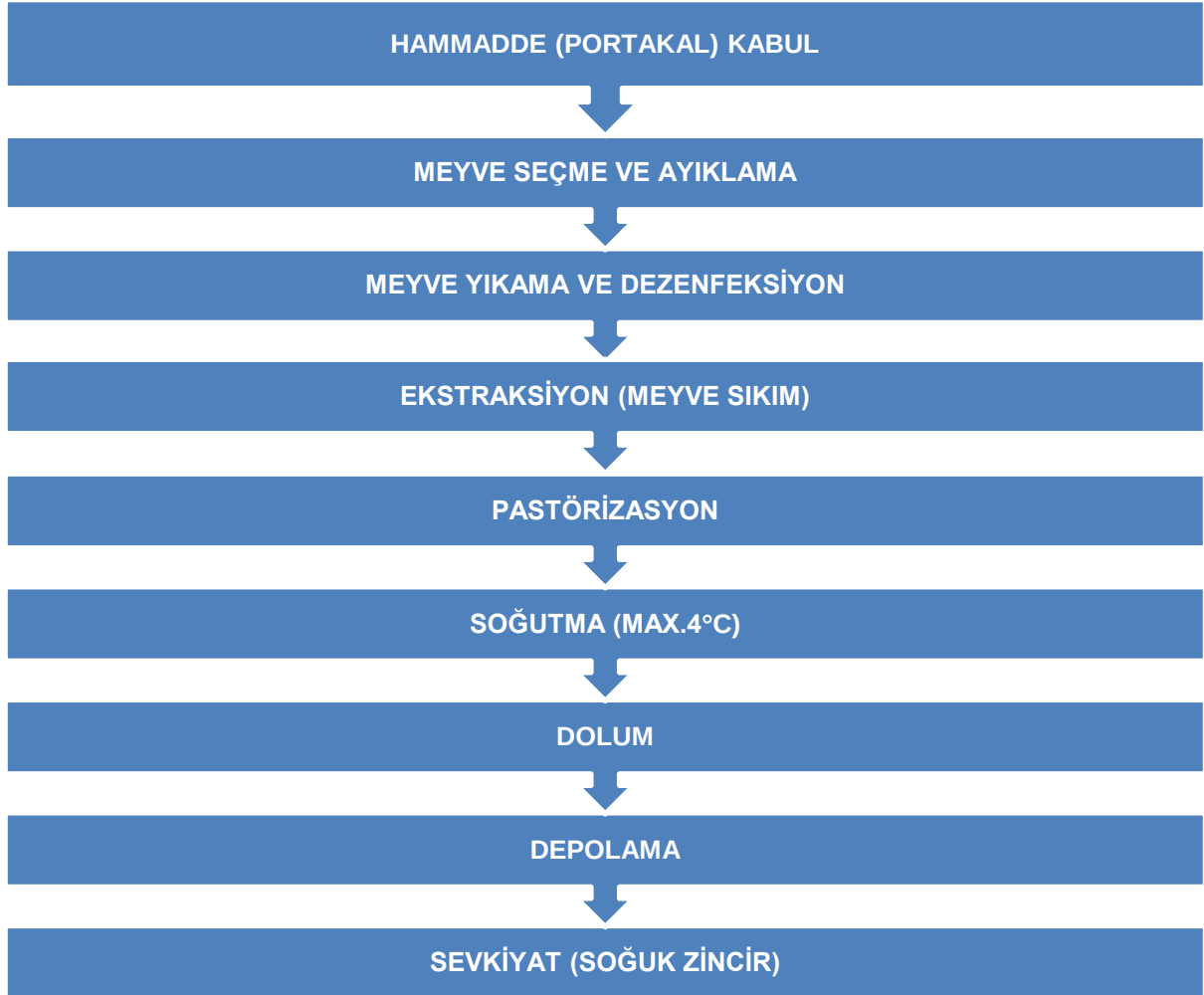
Şekil 4. NFC Portakal Suyu İmalatı Akım Şeması
