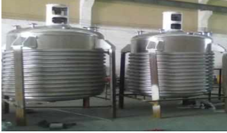
Şekil 32. Karıştırıcı ve Isıtma Bobinli Tanklar
