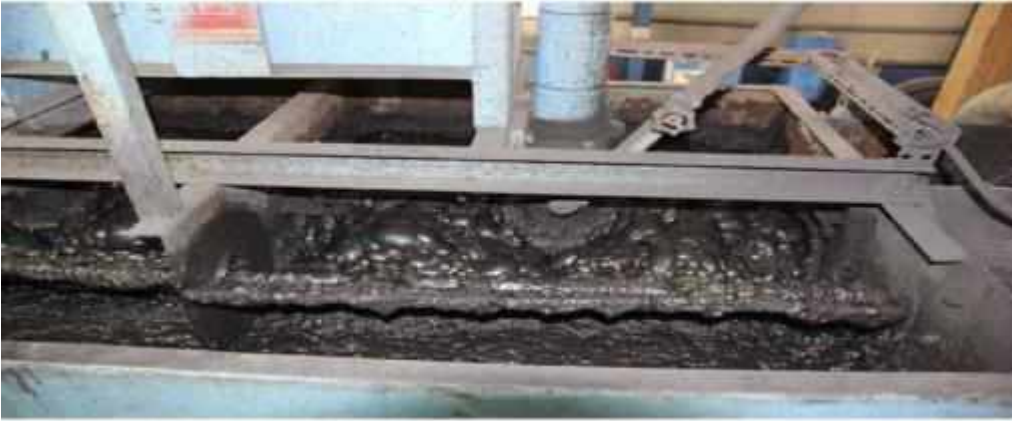
Şekil 13. Köpüklerin Etrafına Absorblanarak Yüzdürülmüş Çinko Sülfür
