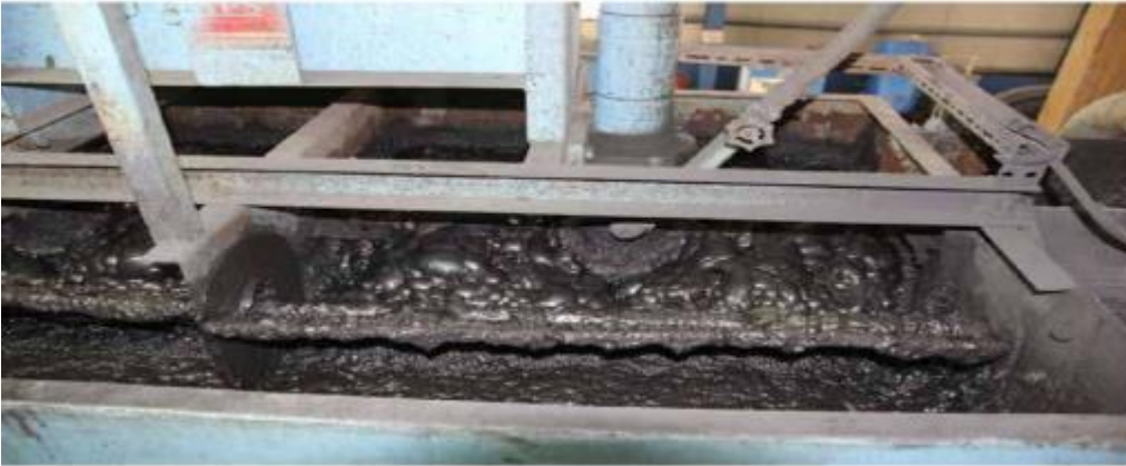
Şekil 13. Köpüklerin Etrafına Absorblanarak Yüzdürülmüş Çinko Sülfür
