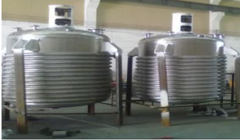
Şekil 32. Karıştırıcı ve Isıtma Bobinli Tanklar
