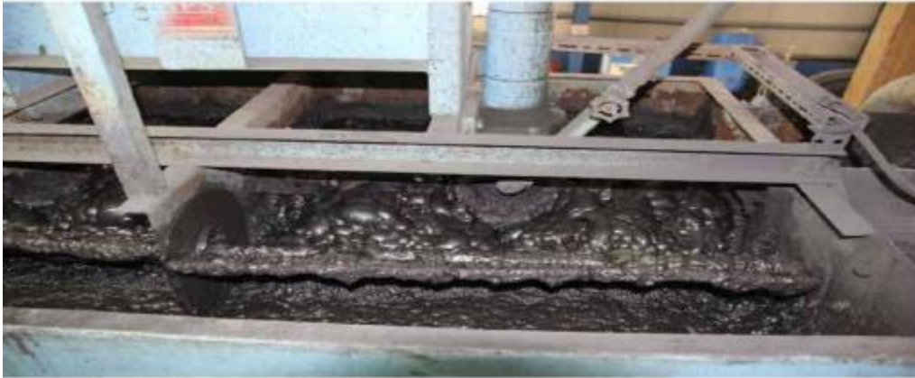
Şekil 13. Köpüklerin Etrafına Absorblanarak Yüzdürülmüş Çinko Sülfür
