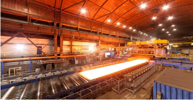
Şekil 12: Sıcak Haddelenmiş Alüminyum Yarı Mamul Konveyör Bandında Soğutulurken
