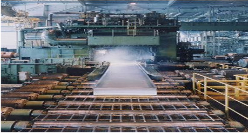
Şekil 12: Sıcak Haddelenmiş Alüminyum Yarı Mamul Konveyör Bandında Soğutulurken
