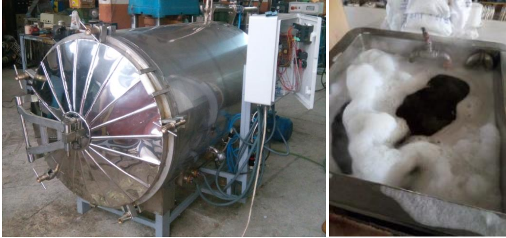
Şekil 10. Fikse ve Çile Boyama Kazanları
