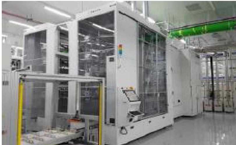
Şekil 23: \text{Al}_2\text{O}_x/\text{SiN} İşlem Makinesi
