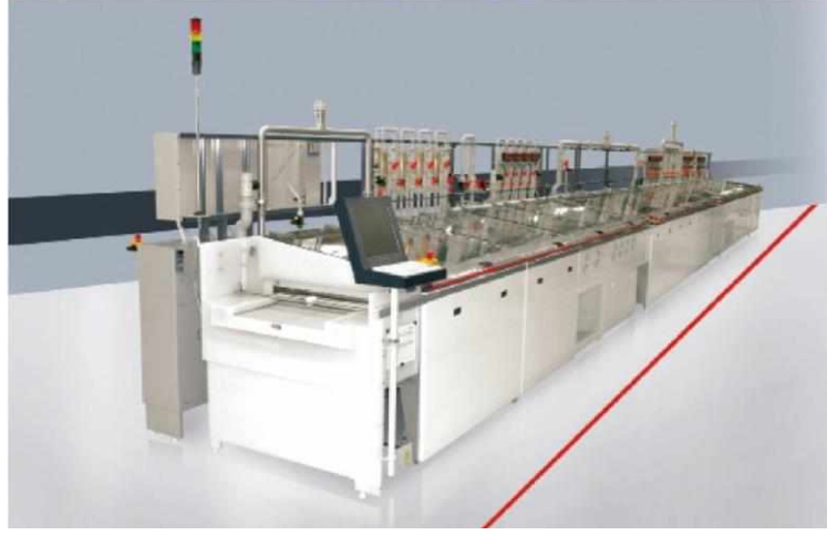
Şekil 22: Tekstüre Etme İşlem Makinası
