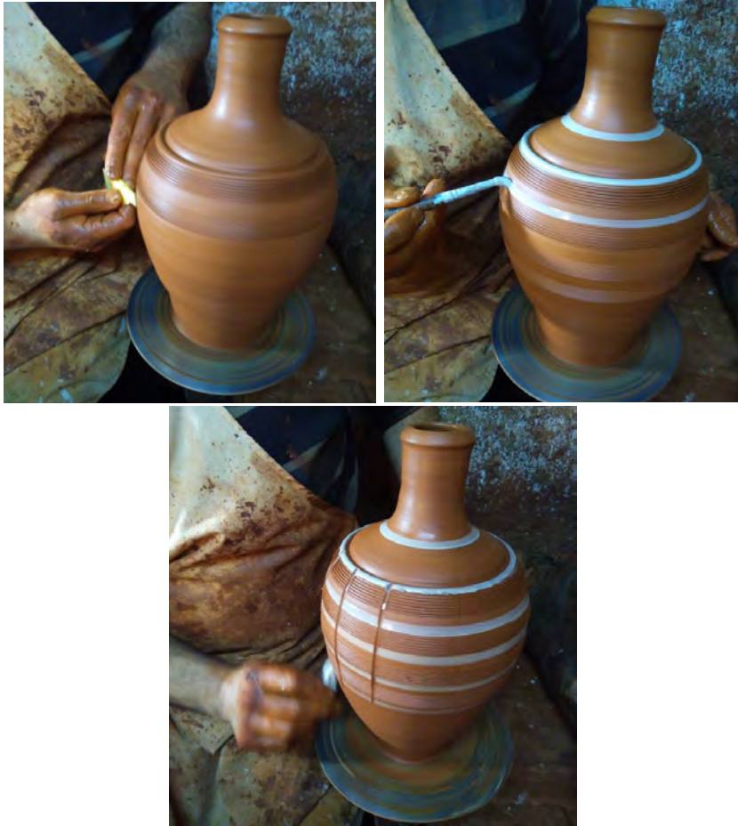
Şekil 16: Çark Üzerinde Tarak ile Dekorlama İşlemi
